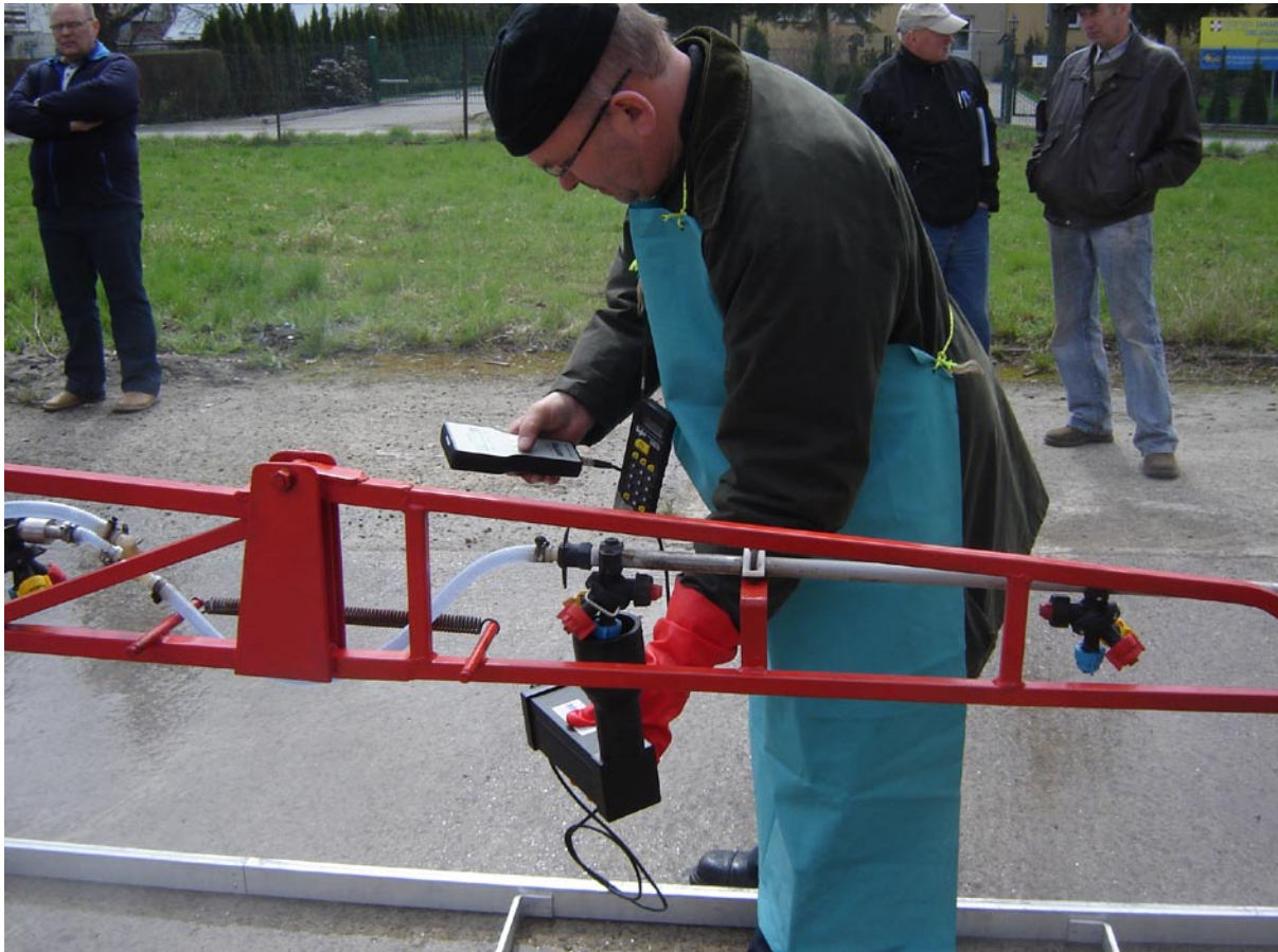
Rys.1 AAMS S-MONITOR NOZZLE TESTER – elektroniczny pomiar wydatku jednostkowego
